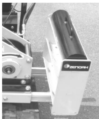
バランスウエイト 中間張り出し状態
