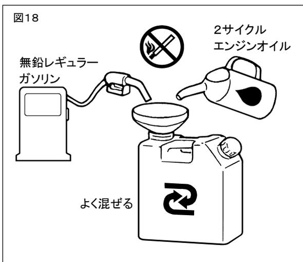
燃料は、自動車用無鉛ガソリンと空冷2サイクルエンジン用オイルを下記割合で混合容器に入れ、容器を振ってよく混ぜ合わせたものを使用してください。
