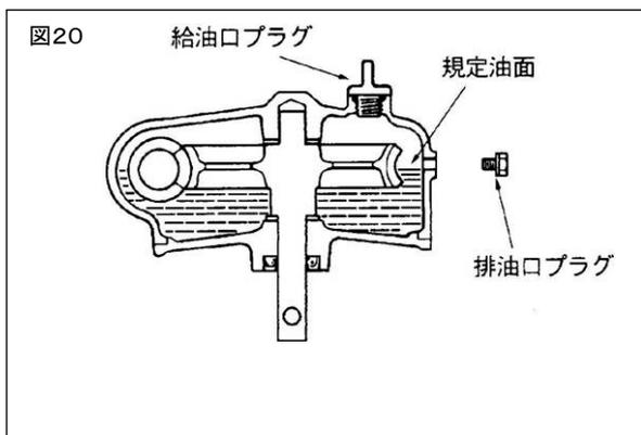
ギヤケース内のオイルは、最初は使用50時間目に、以後は使用100時間毎新しいオイルと交換してください。(図20)
