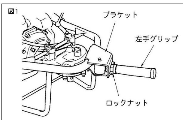
付属の左手グリップを本体フレームのブラケットにねじ込みロックナットをスパナ(対辺22mm)でしっかりと締め付けてください。(図1)
