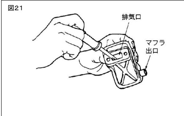
1. マフラを外して、排気口にドライバを入れてカーボンを落してください。同時にマフラ出口のカーボンも落してください。(図21)
