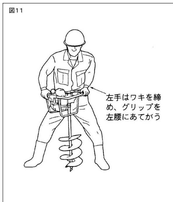
1. 穴を開ける位置にドリルの先端を軽く置いて機体を垂直に立て、スロットルレバーをゆっくり引いてエンジンの回転を徐々に上げてください。
