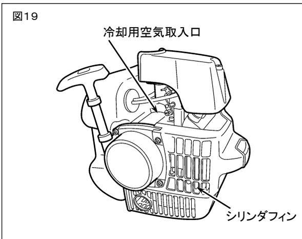
使用25時間毎に冷却用空気取入口やシリンダの冷却フィン回りを点検し、付着したゴミを取り除いてください。(図19)
