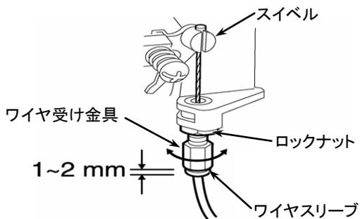
1. ロックナットをゆるめ、ワイヤ受け金具を左右いずれかに回します。（図14）
