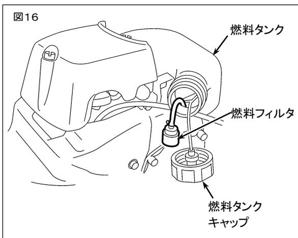
使用25時間毎を目安に、燃料タンクから燃料フィルタを取り出し、詰まりの有無を点検してください。(図16)
