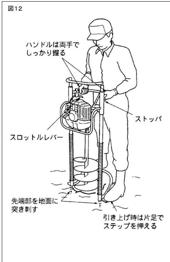
1. 穴を開ける位置にドリルの先端を合わせてオーガーを垂直に立て、左手でストップを引いてオーガーを押し下げてください。
