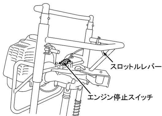
1. スロットルレバーを完全に戻してアイドリングで1～2分間冷却運転してください。
