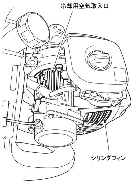
25時間使用毎に冷却用空気取入口やシリンダの冷却フィン回りを点検し、付着したゴミを取り除いてください。
