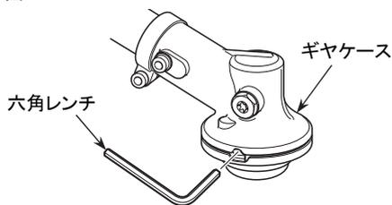
1. 刃受金具の固定穴とギヤケースの差込穴を合わせて付属品の六角レンチを差し込み、軸が回らないように固定してください。
