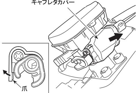
2. キャブレタカバーを取り外してください。キャブレタカバーの爪を外側に開くと簡単に外れます。
