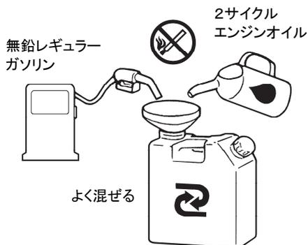
燃料は、自動車用無鉛ガソリンと空冷2サイクルエンジン用オイルを下記割合で混合容器に入れ、容器を振ってよく混ぜ合わせたものを使用してください。
