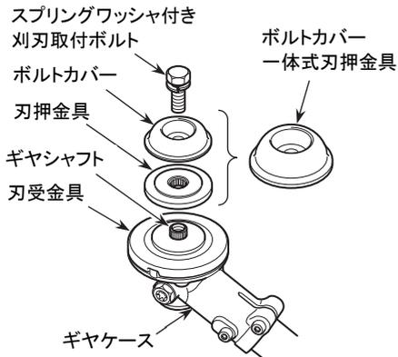
3. スプリングワッシャ付き刈刃取付ボルト、刃押金具およびボルトカバーを外してください。
