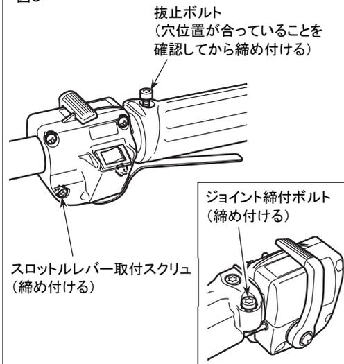
4. 指で抜止ボルトを奥までねじ込み、メインパイプが回らないことを確認してから確実に締め付けてください。
