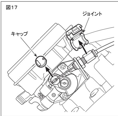
3. ワイヤ受金具を固定しているジョイントとワイヤの端子外れ防止キャップを取り外してください。
