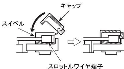
7. ジョイントを取り付けて、ワイヤ受金具とワイヤスリーブを固定してください。
