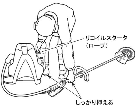
4. 機体を安定した地面に置き、刈刃の周囲の安全を確かめてから、右足でフレーム、左手でメインパイプを押えながら右手でスタータノブを引いてください。
