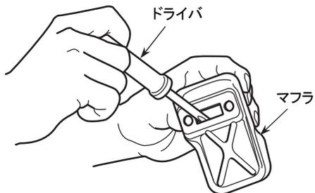
1. マフラを外して、排気口にドライバを入れてカーボンを落してください。同時にマフラ出口のカーボンも落してください。
