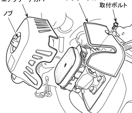
1. エアクリーナカバーのノブをゆるめてカバーを取り外し、取付ボルト(M5×20)を外してエアクリーナガードを取り外してください。
