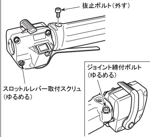
1. ジョイント端部中央の抜止ボルト(M5×9)を取り外し、ジョイント締付ボルト(M5×20)およびスロットルレバー取付スクリュー(M4×20)4本をゆるめてください。
