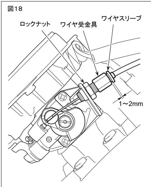
スロットルワイヤの遊びは、コントロールレバーを始動位置にしてスロットルレバーを完全に戻し、ワイヤ受金具から出ているワイヤスリーブを指でつまんで軽く引いた時に、1~2mm 動く程度であれば適正です。
