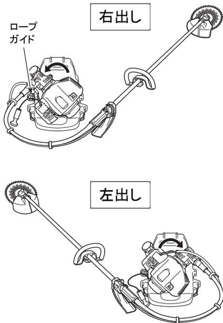
**補足** この刈払機は右出し、左出し両方の操作が可能です。右出しから左出し、または左出しから右出しに竿を持ち換える場合は、必ずエンジンを停止し、背負いフレームを地面に降ろしてから竿の向きを変え、背負い直してください。
