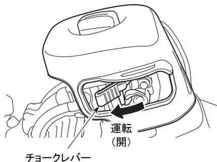
5. 初爆後、しばらくそのままにしてエンジンの状態を確認してください。エンジンが停止した場合、チョークレバーを運転(開)位置に戻し、再度スタータロープを引いてください。エンジンが回り続けている場合、約10秒後にチョークレバーを運転(開)位置に戻してそのまま暖気運転をしてください。
