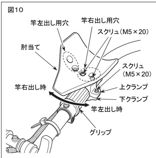
1. 上クランプおよび下クランプをスクリュ (M5×20) 2本でしっかりと締め付けてください。
