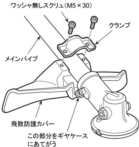
付属の飛散防護カバーの先端をギヤケースにあて、付属のクランプでメインパイプに取り付け、ワッシャ無しスクリュ (M5 x 30) 2本で均等に締め付けてください。
