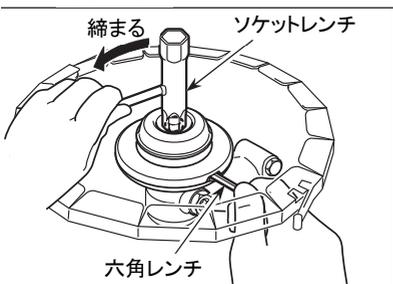
8. 六角レンチで回り止めをしてから、スプリングワッシャ付き刈刃取付ボルトをソケットレンチで反時計方向に回して確実に締め付けてください。
