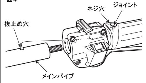
3. メインパイプを軽く左右に回しながらメインパイプの抜止め穴とジョイントのネジ穴が合うようにジョイントに押し込んでください。
