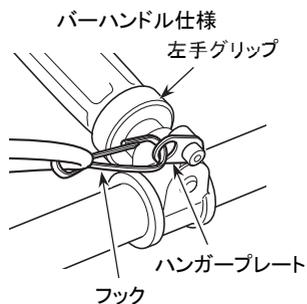
付属の吊りバンドの取付けフックを、背負いバンドの吊りバンド取付金具に取り付け、バンドを使いやすい長さに調整してください。
