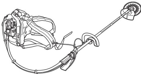
**重要** フレキシブルシャフトを曲げるとスロットルワイヤの遊び量が変わります。遊び調整は、フレキシブルシャフトを作業時に近い状態にして行ってください。
